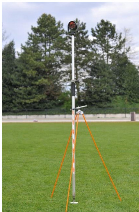
Originele meetstok met prisma boven (zoals landmeters dit doen)
