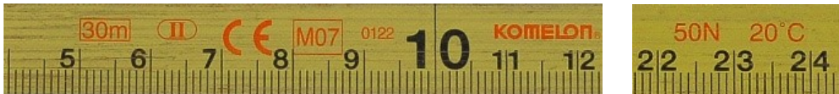
Merktekens op een geverifieerd meetlint
