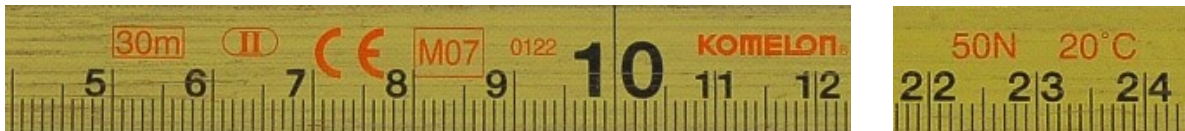
Merktekens op een geverifieerd meetlint
